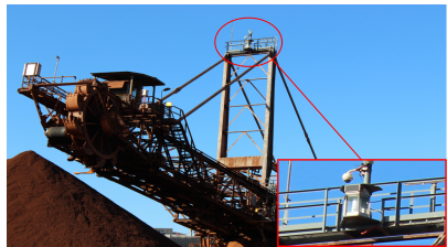
图 2 3D 扫描仪安装扫描示意图
