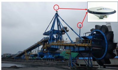
图 3 RTK-GNSS 安装扫描示意图
